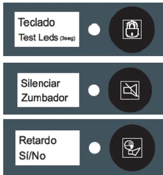
**TECLADO:** Presionando durante 3 segundos, se realiza una prueba de leds, se iluminan todos los leds y suena el zumbador interno durante unos segundos.
